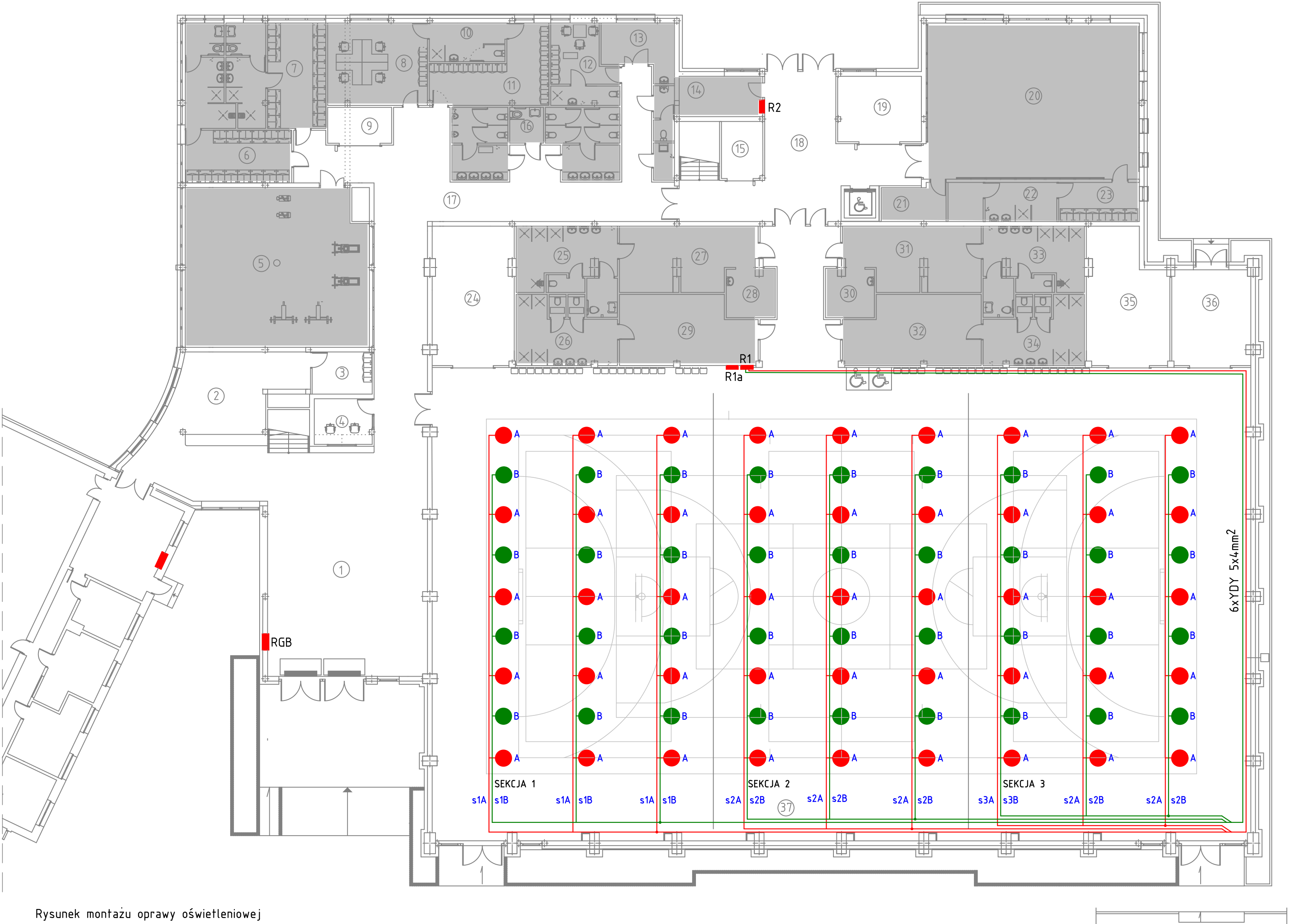
Rysunek montażu oprawy oświetleniowej
